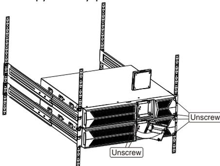
4. Снимите переднюю панель и подключите клемму батареи (А) от ИБП к клемме ЕВМ (В), как показано ниже. Пользователям необходимо снять небольшую заслонку (С) со стороны передней панели, чтобы выпускной провод ЕВМ прошел через заслонку, а затем собрать переднюю панель.
