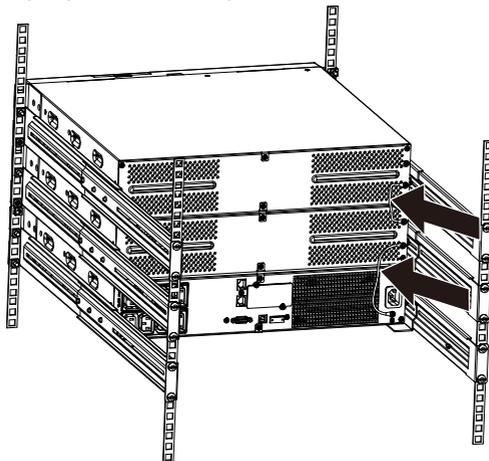
2. Снимите переднюю панель и подключите клемму батареи (А) от ИБП к клемме EBM (В), как показано ниже. Затем подключите клемму аккумулятора (D) от первого EBM к клемме аккумулятора (Е) от второго EBM. Пользователям необходимо снять небольшую заслонку (С) со стороны передней панели, чтобы выпускной провод EBM прошел через заслонку, а затем собрать переднюю панель.
