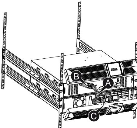
5. После установки ИБП в стойку к нему можно подключить нагрузку. Перед подключением всех нагрузок к розетке убедитесь, что оборудование нагрузки выключено.
