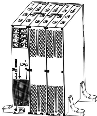
2. Снимите переднюю панель и подключите клемму батареи (А) от ИБП к клемме ЕВМ (В), как показано ниже. Затем подключите клемму аккумулятора (D) от первого ЕВМ к клемме аккумулятора (Е) от второго ЕВМ. Пользователям необходимо снять небольшую заслонку (С) со стороны передней панели, чтобы выпускной провод ЕВМ прошел через заслонку, а затем собрать переднюю панель.
