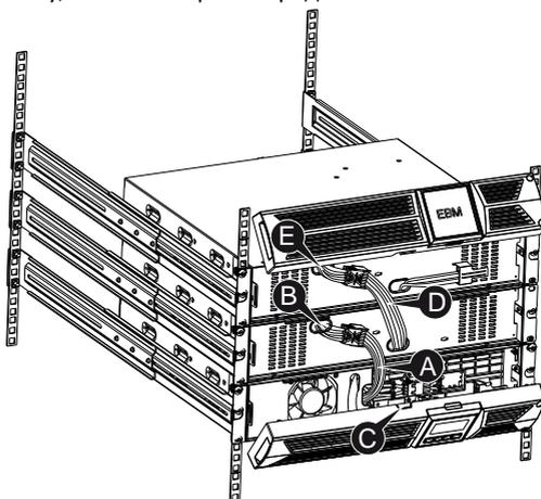
**Примечание:** К ИБП можно подключить три или более модулей EBM таким же образом, как показано выше.
