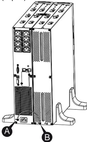
4. Снимите переднюю панель и подключите клемму батареи (А) от ИБП к клемме ЕВМ (В), как показано ниже. Пользователям необходимо снять небольшую заслонку (С) со стороны передней панели, чтобы выпускной провод ЕВМ прошел через заслонку, а затем собрать переднюю панель.
